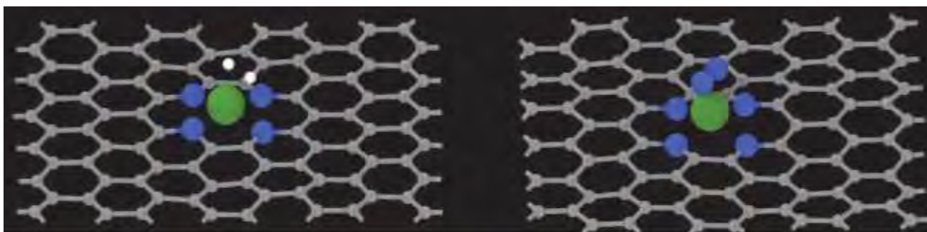
Figura 1 - Hidrógeno molecular (izquierda) y Nitrógeno molecular (derecha) adsorbidas sobre el catalizador basado en grafeno modificado en simulaciones ab-initio a 600K. Referencia de colores: C (gris) | N (Azul) | Cr (Verde) | H (Blanco)
