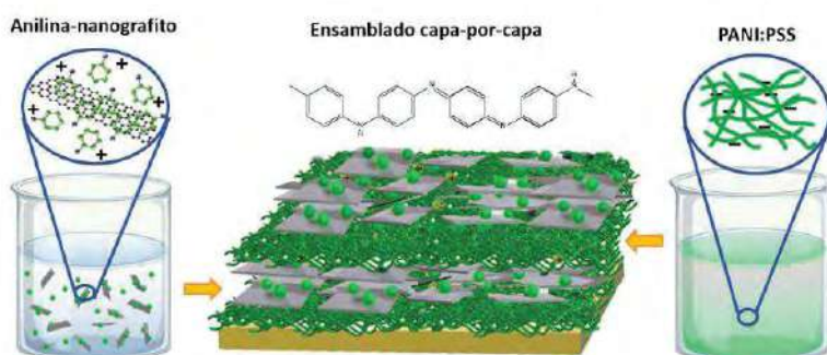
Figura 1. Esquema del ensamblado LbL realizado a partir de una dispersión de nanografito en anilina y el complejo PANI:PSS
