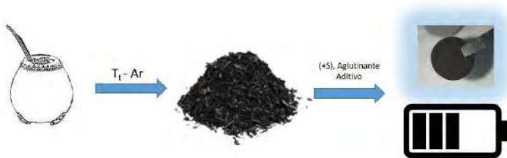
Figura 1. Esquema del método de síntesis y aplicación del biocarbón obtenido a baterías de litio.
