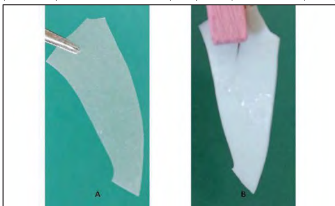
Figura 2 -Membrana de copolímero FDIP50N- a temperaturas T < LCST (A) y T > LCST (B).
