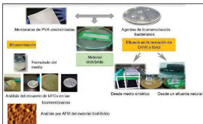
Figura 1 - Síntesis del material biohíbrido y determinaciones realizadas. Se analizó la eficacia biorremediadora del material frente a Cr(VI) y fenol empleando medio de remoción sintético y un efluente natural de curtiembre.
