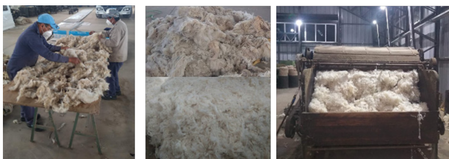
Figura 5: Clasificación (izq.), lavado (centro) y cardado (der.)
