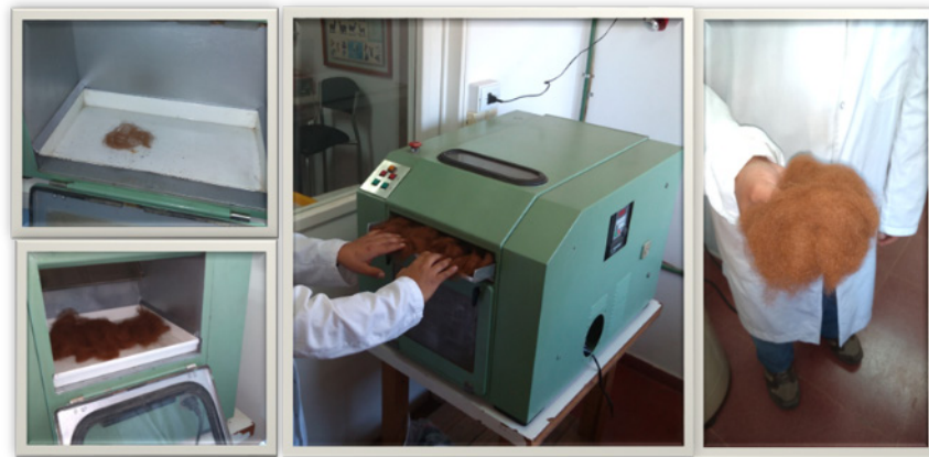
Figura 2: Ensayo de laboratorio de descordado de fibra de llama
