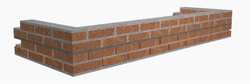
Figura 30. Esquema de hileras de ladrillos por debajo y por encima de la capa aisladora
