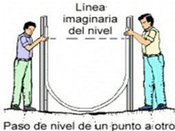
Figura 19. Paso de nivel mediante manguera de nivel
