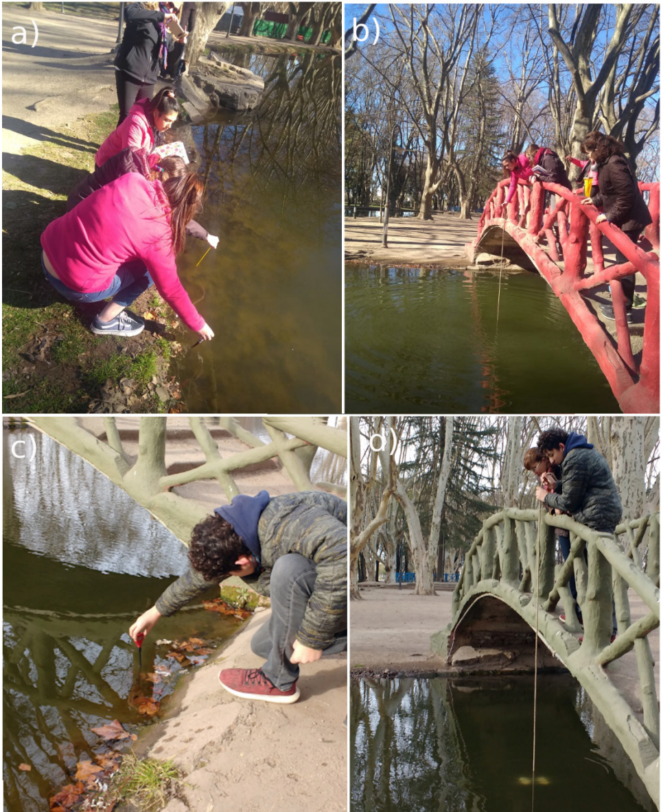
Fig. 1. Medición de variables ambientales en el lago del Parque Sarmiento. Registro de pH, temperatura, conductividad con sensores portátiles (a, c) y medición de profundidad y turbidez con disco de Secchi (b, d).
