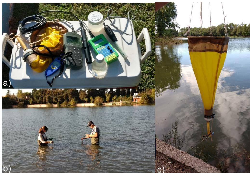
**Figura 2.** a) Sensores para el registro de variables físico-químicas, b) registro de variables en el cuerpo de agua, c) red de fitoplancton.
