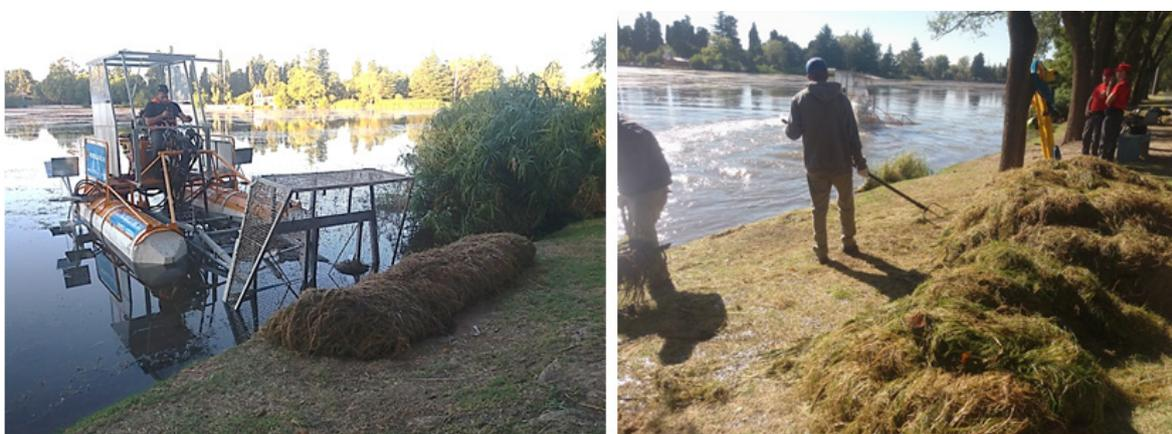
**Figura 13.** El crecimiento desmedido de las plantas acuáticas motivó la utilización de embarcaciones diseñadas para su extracción.
