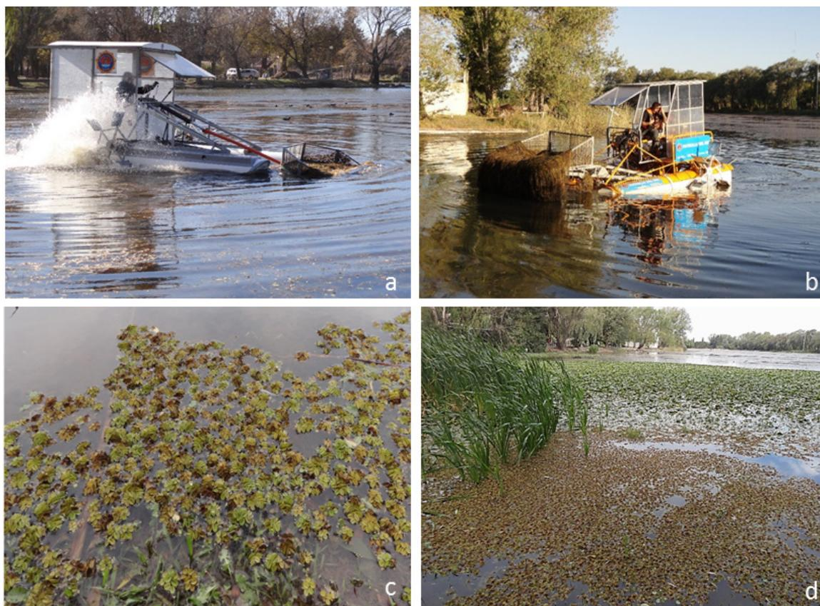
**Figura 9.** El crecimiento de hidrófitas en Dalcar motivó la utilización de “máquinas cosechadoras” para su control (a y b) y la realización de un control mecánico para evitar la expansión de la macrófita flotante *S. minima* (c y d).
