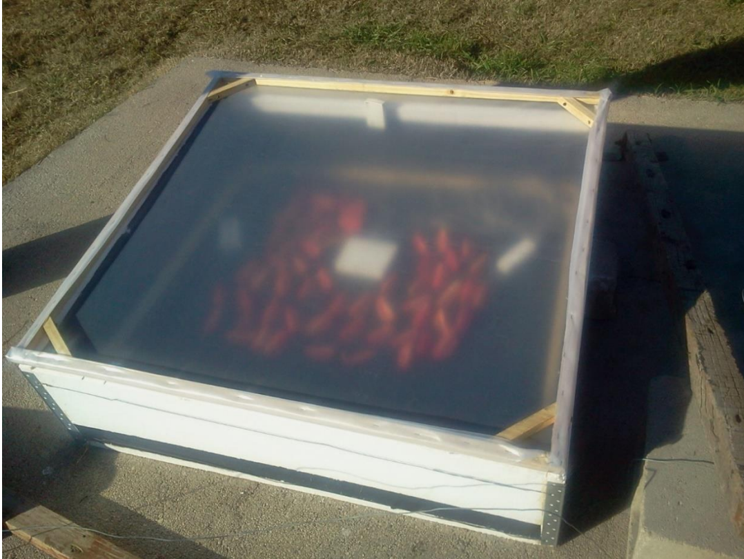
Foto 1: Vista superior del secador solar directo con secado de tomates.
